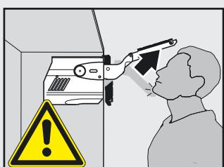
Существует опасность травмы выскакивающим вверх телескопическим рычагом.
