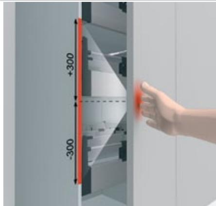
Оптимальное открывание обеспечивается, когда механизм TIP-ON устанавливается в той области, где обычно находится ручка. При необходимости позиция TIP-ON может отклоняться по высоте на  $\pm 300$  мм и по ширине на  $1/4$  корпуса. Для больших дверей также только 1 шт. на дверь.
