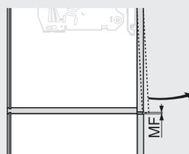
MF Минимальный зазор при открывании (2мм)
