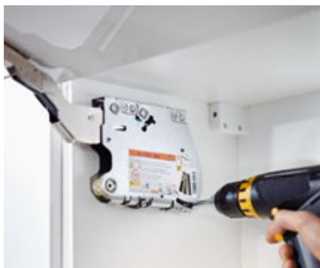
Тонкая настройка силы открывания и закрывания на силовом механизме осуществляется шуруповертом (с насадкой Pozidriv®, размер 2, длина 39 мм).
