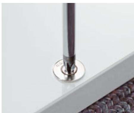
4. Пластина на саморезы прикручивается без лишних усилий.
